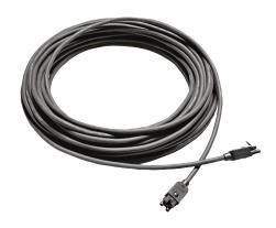
这是一种特制的电缆,包含用于数据和音频通信的 2 根塑料光纤和用于供电的 2 根铜芯。 该电缆交货时已装配了网络连接器。此电缆可用于将 CCU 连接至音频扩展器。
